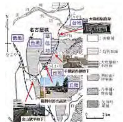
図3：地形に応じて建設された中央本線と駅
